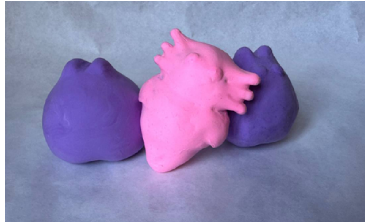
Figura 21: Prototipos de TPU cubiertos de pasta flexible.
