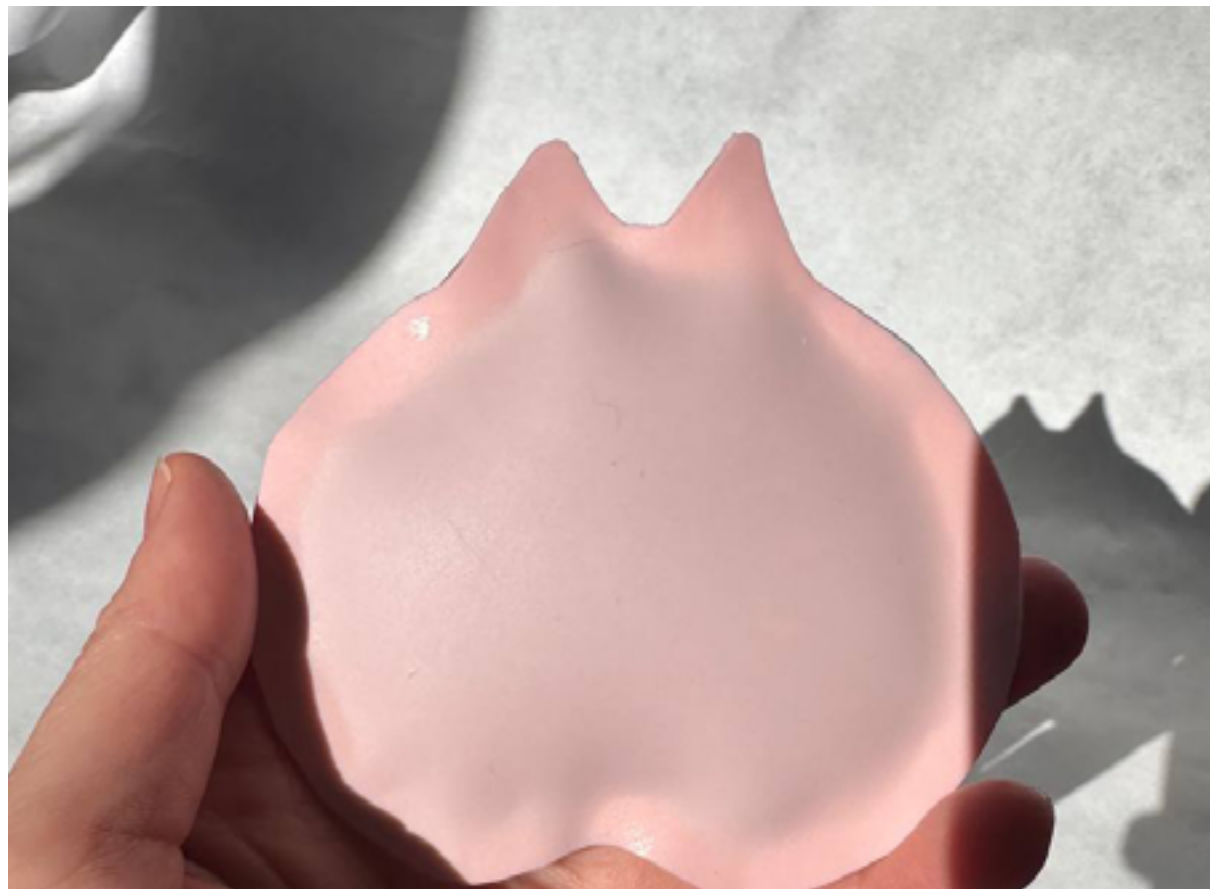
Figura 20. Prototipos funcional hecho de silicona y relleno de gel térmico.
