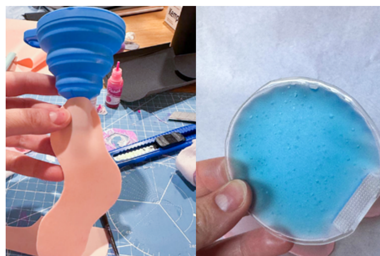
Figura 16. Prototipo de parche en silicona, rellando con gel térmico.
